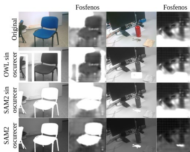
Figura 2. Ejemplos con dos objetos ('silla' y 'llaves'), con distintas configuraciones de visualización (sólo detector – OWL– o también segmentador –SAM2– y oscureciendo).
