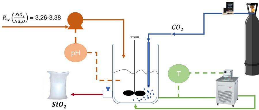
Figura 1. Esquema de la planta de precipitación de la sílice.
