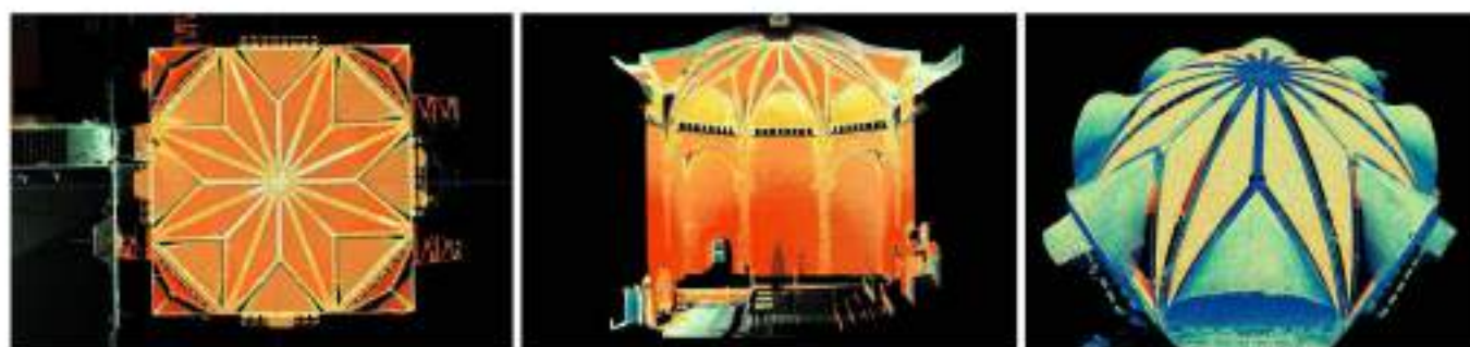
[8] NAPOLI, CASTEL NUOVO, RILIEVO DELLA GRAN SALA, 2019 (RILIEVO CON LASER SCANNER DI RAFFAELE AMORE E GIAN PAOLO VITELLI).
