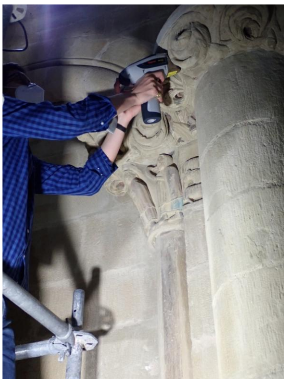
Figura 2. Análisis mediante pXRF en un capitel de la sala de Doña Petronila (Museo de Huesca).
