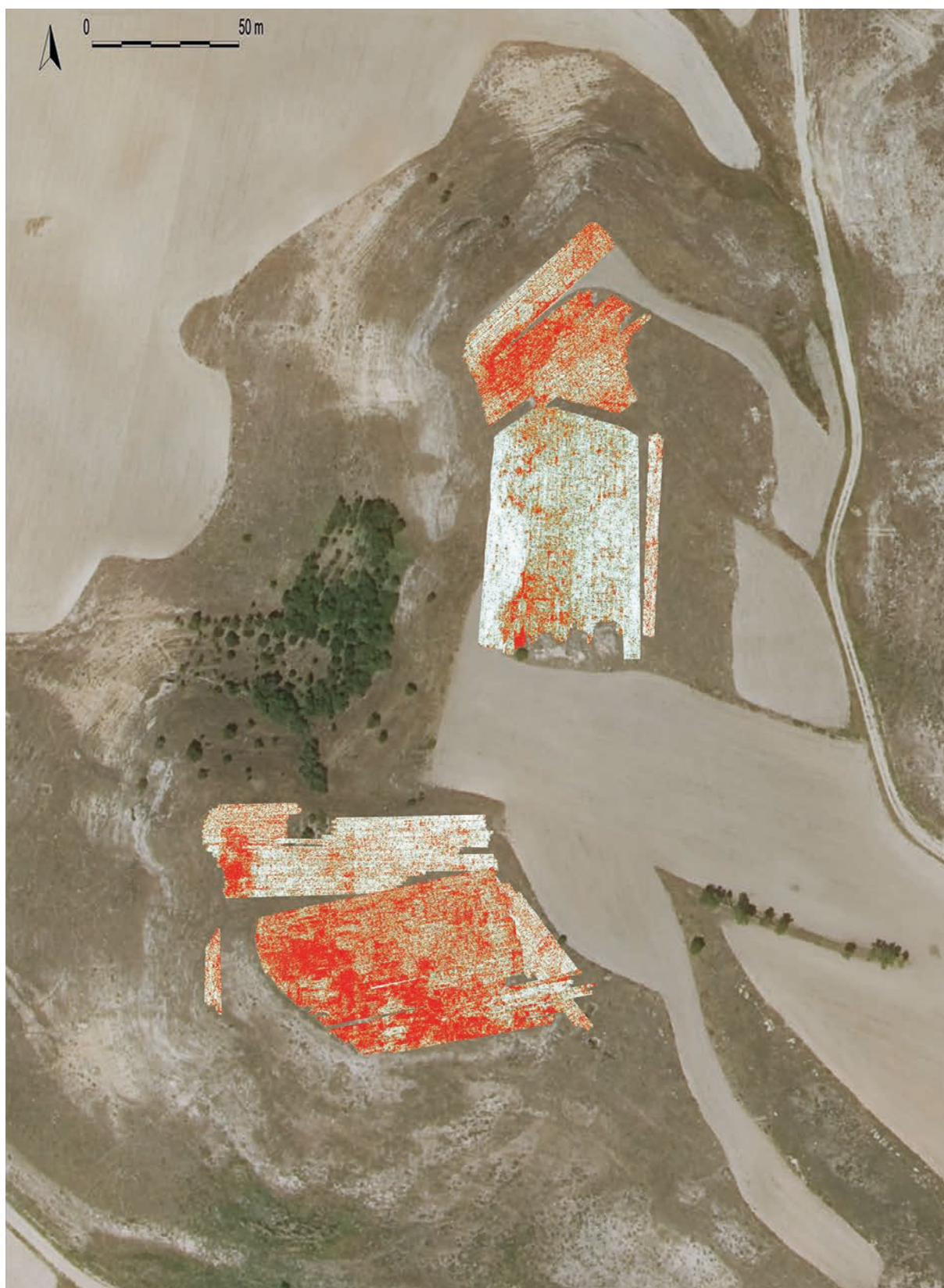
Figura 10. Superposición gráfica de los transectos obtenidos de la prospección geofísica con GPR sobre la ortoimagen del Plan Nacional de Ortofotografía Aérea del Instituto Geográfico Nacional. Imagen de base: PNOA_ANUAL_2024_OF-Exp_ETRS89_HU30_h05_0608-5-2. (Imag. I. Hortelano).
