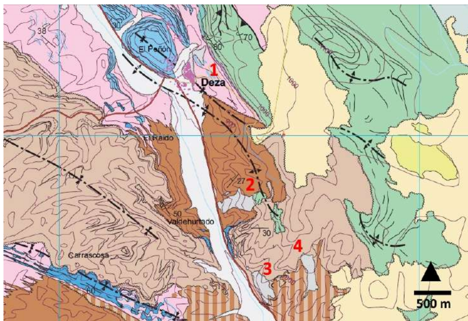
Figura 2. Mapa geológico del entorno de Deza (Huerta 2006). Cretácico Superior (verde), Paleógeno y Neógeno (otros colores), Cuaternario aluvial (gris claro), Tobas cuaternarias (gris oscuro).
