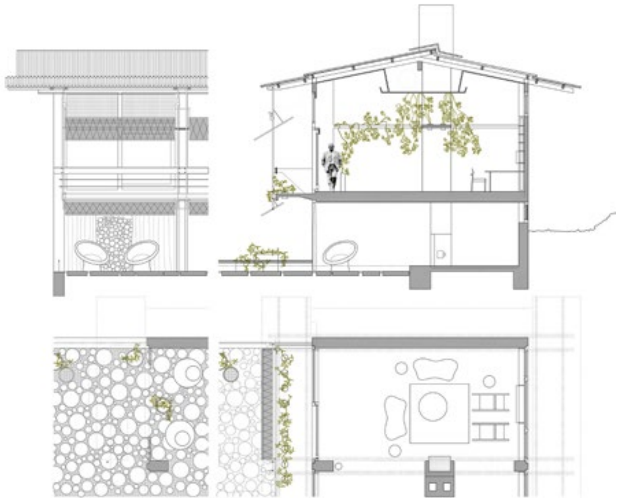
Figura 5. Módulo de la fachada y envoltorio del volumen de vivienda.
