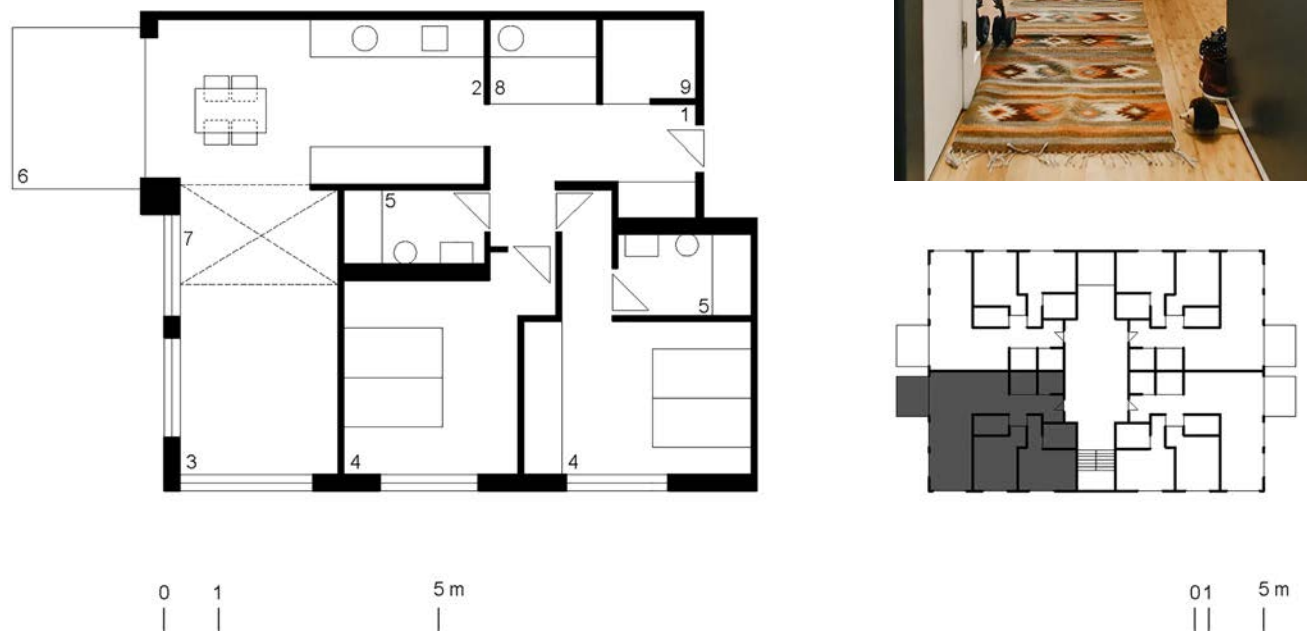
Figura 5. Vivienda teórica del manual Planing for Children New Vertical Communities , Toronto, Canadá. Ayuntamiento de Toronto, 2020. Planta vivienda tipo: 1 recibidor; 2 cocina; 3 estar; 4 dormitorio; 5 aseo; 6 terraza; 7 zona de juegos; 8 ciclo de la ropa; 9 almacén.
