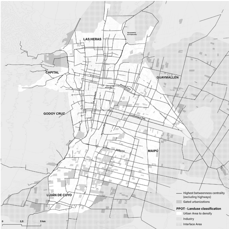
Figura 5. Estudio de la malla de vías intermedias del Área Metropolitana de Mendoza. En negro destacan aquellos segmentos viarios equivalentes al decil mayor de “betweenness centrality” (Normalized Angular Choice, Radio métrico 20.000m).
